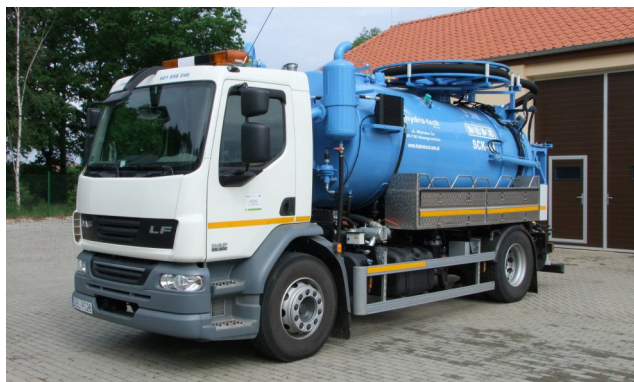
Samochód do czyszczenia sieci wodno-kanalizacyjnej
